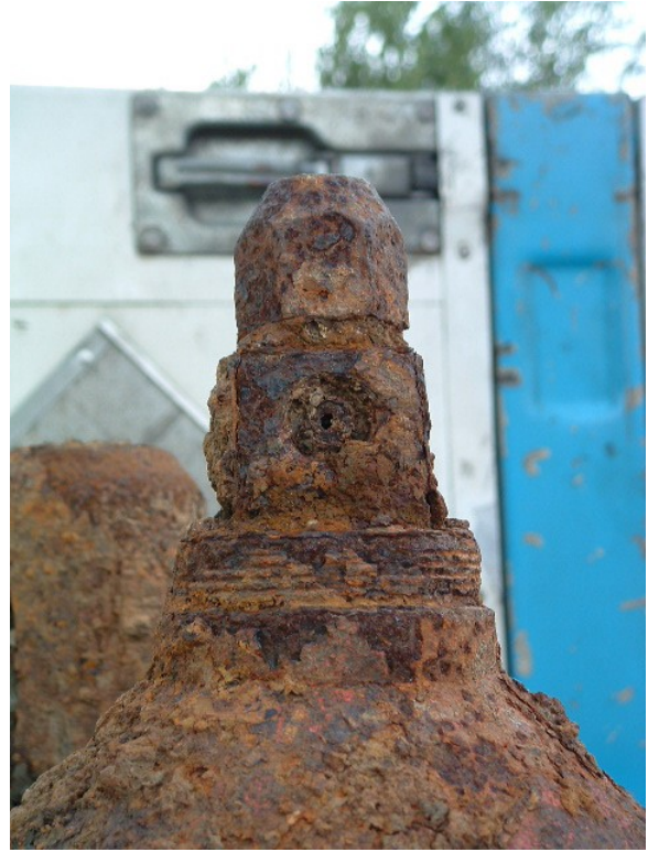
Exemple d'une bouteille d'acétylène extrêmement corrodée.
