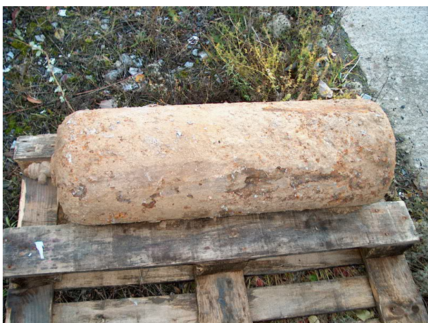
Exemple d'une bouteille extrêmement corrodée qui pourrait contenir un gaz toxique sous pression.
